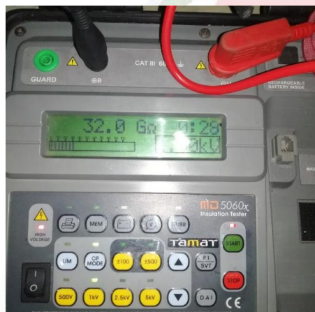
ทดสอบค่าความเป็นฉนวนระหว่างเฟส
