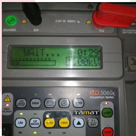
ทดสอบค่าความเป็นฉนวนระหว่างเฟส
