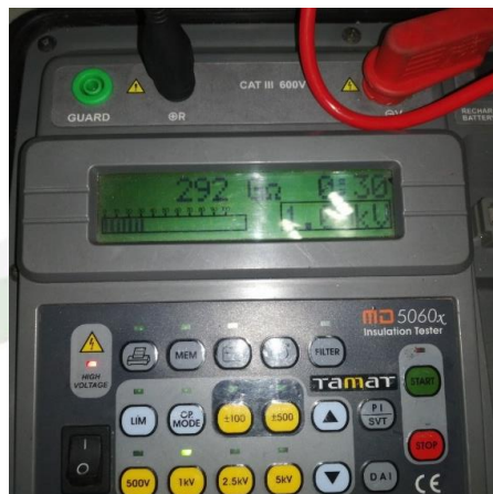
ทดสอบค่าความเป็นฉนวนระหว่างเฟส
