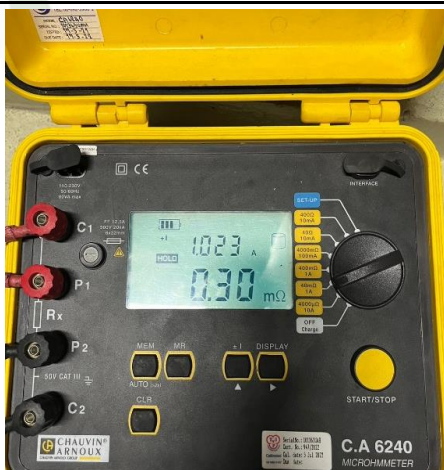
ทดสอบค่าความต้านทานหน้าสัมผัสตัวนำไฟฟ้า
