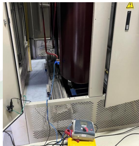
ทดสอบค่าความเป็นฉนวนของขดลวด
