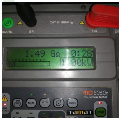
ทดสอบค่าความเป็นฉนวนระหว่างเฟส
